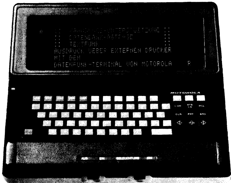
Zum Einsatz im Fahrzeug: das Datenfunkterminal mit drei Speichern und Bildschirm für 240 alphanumerische Zeichen.
